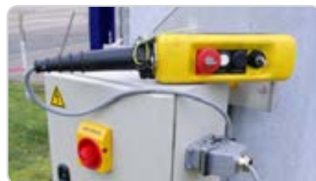
Sécurité dans la commande des manœuvres par boîtier déporté
