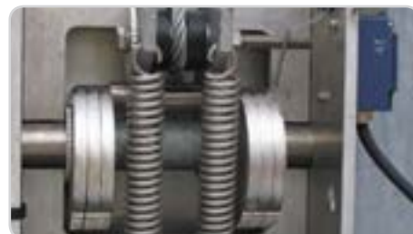
Sécurité anti-chute assurée par un frein parachute à came
