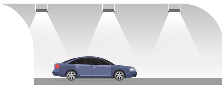
Les projecteurs sont installés de manière symétrique de part et d'autre du tunnel ou implantation axiale.
